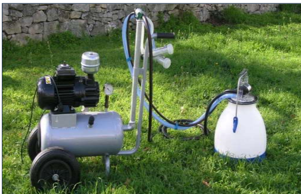
Slika 4.4. Aparat za mužnju magarica
