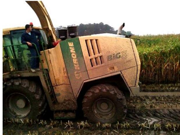
Slika 9. Samohodni silokombajn Krone
