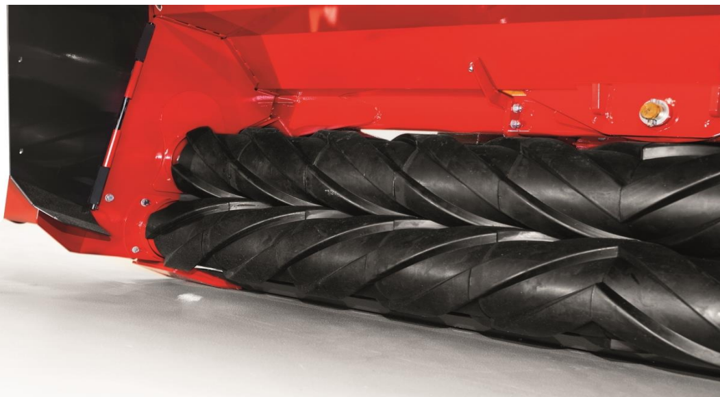
Slika 5. Gnječilica ugrađena na kosilicu
