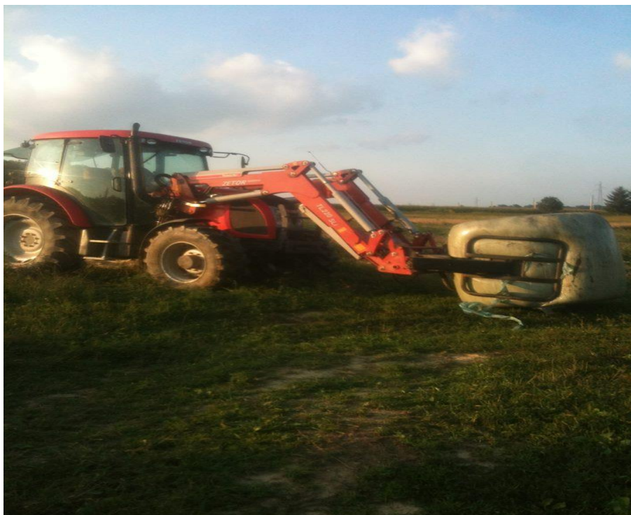
Slika 23. Traktor s prednjim traktorskim utovarivačem i hvataljkama za bale
