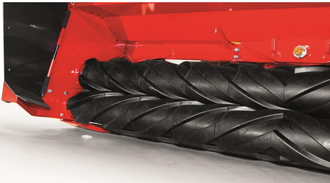
Slika 5. Gnječilica ugrađena na kosilicu
