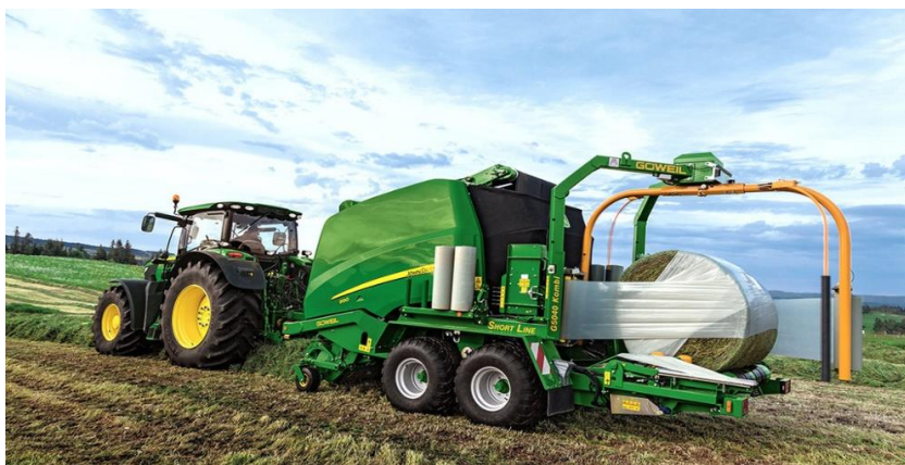
Slika 14. Preša i omotač u jednom stroju
