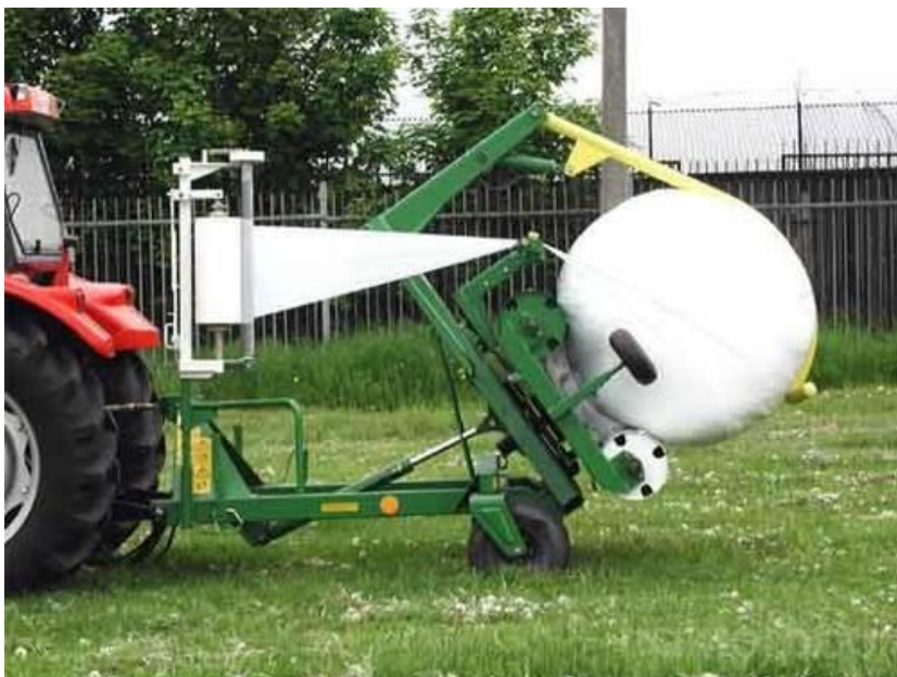
Slika 13. Spuštanje bale na tlo
