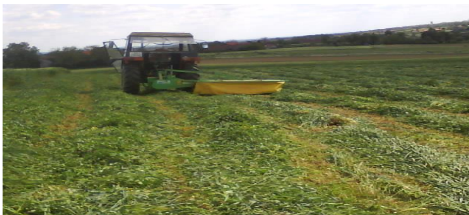
Slika 16. Kosilica s bubnjevima marke SAMASZ u radu
