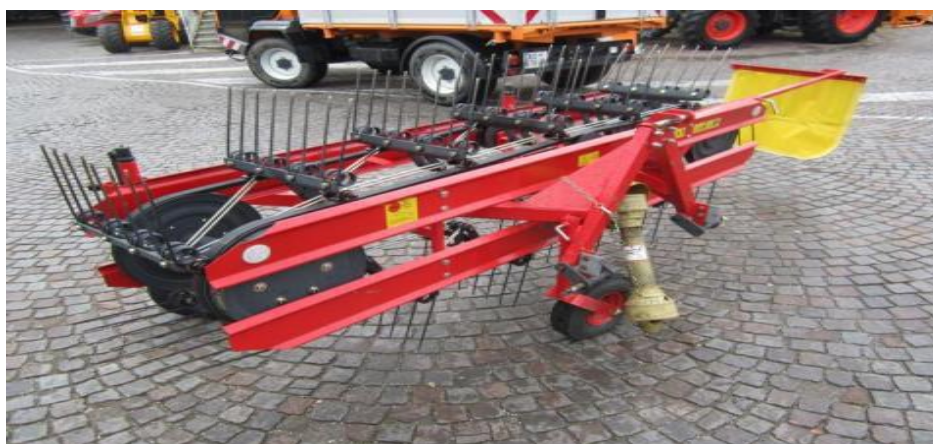
Slika 7. Okretač i sakupljač s beskonačnim remenom
