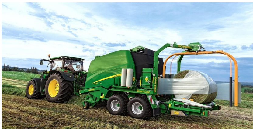
Slika 14. Preša i omotač u jednom stroju
