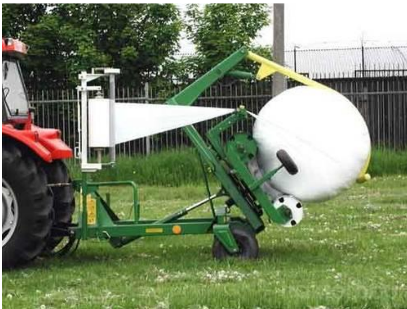
Slika 13. Spuštanje bale na tlo
