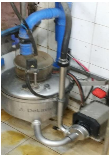
Slika 10. Spremnik za mlijeko
