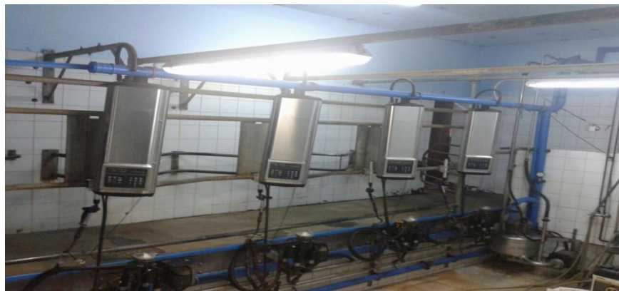
Slika 5. Izmuzište tipa Riblja kost
