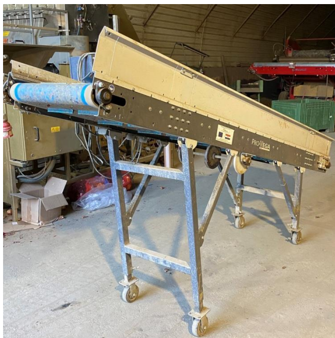
Slika 25. Transportna traka tipa „labud“ marke Pro-Vega
