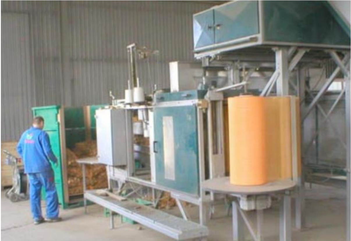
Slika 14. Automatska vaga Manter 8000 s linijom za pakiranje u raschel vrećice
