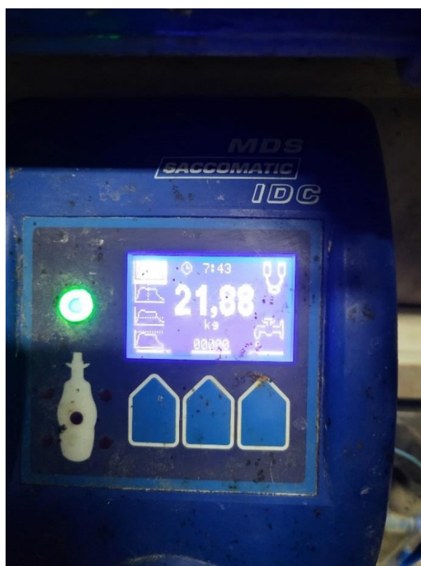
Slika 15. Uređaj za nadzor mužnje - pokazuje količinu mlijeka i vrijeme mužnje
