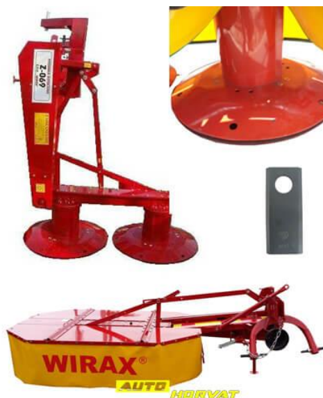
Slika 3. Bubnjasta kosilica s dva bubnja (Wirax).
