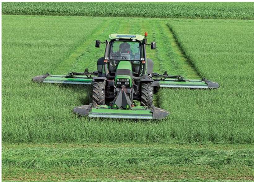
Slika 5. Košnja s prednjom i dvije bočne kosilice (Deutz Fahr).
