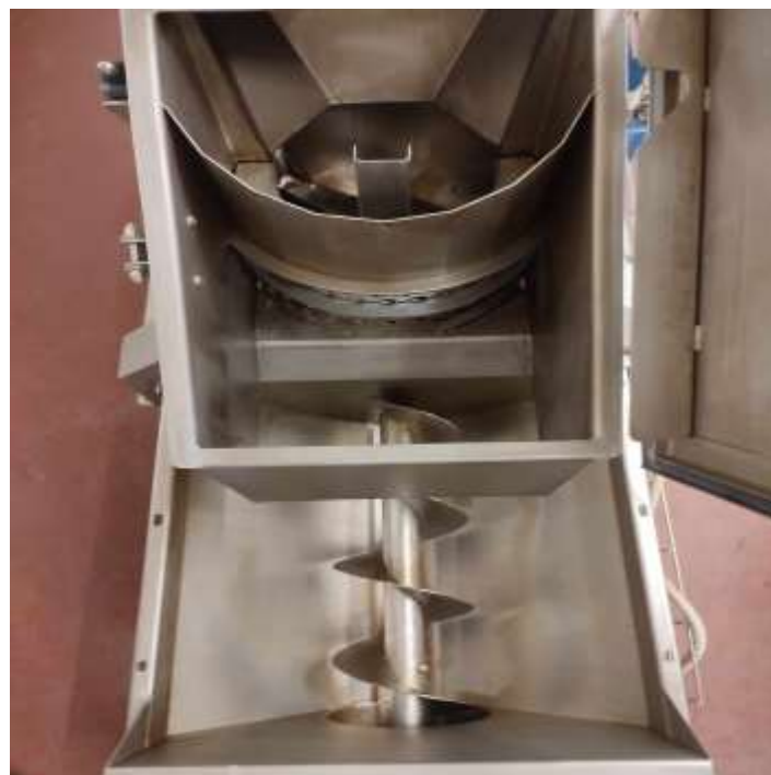
Slika 5. Mlin za mljevenje
