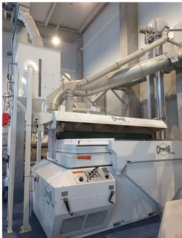
Slika 15. Gravitacijski separator ili stol
