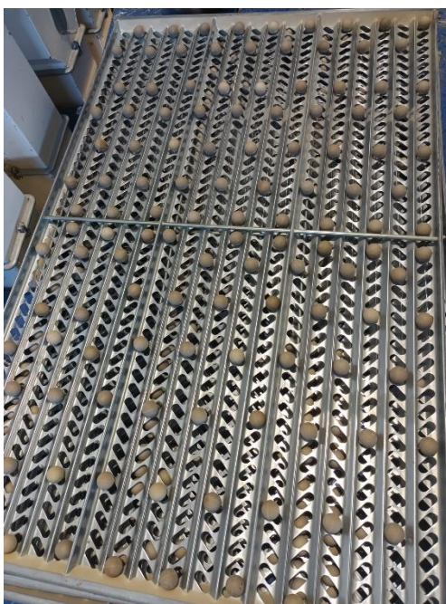
Slika 14. Gumene kuglice na rešetkama
