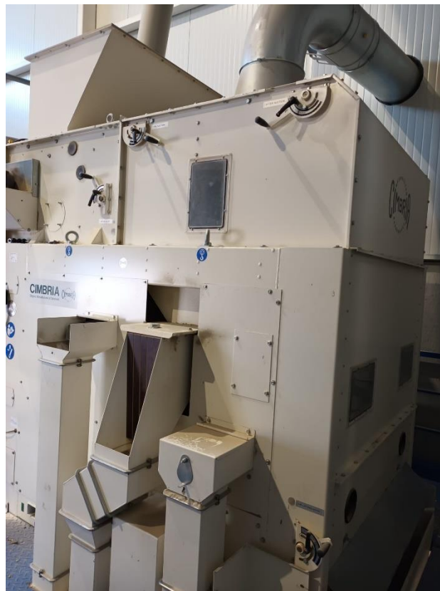
Slika 9. Aspirator ili predčistač
