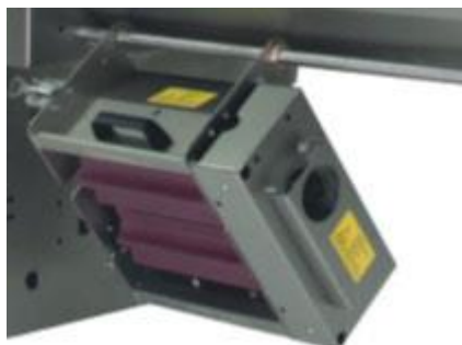
Slika 10. Jedinica za gnječenje Izvor: Mori-Tem uputstva o korištenju stroja
