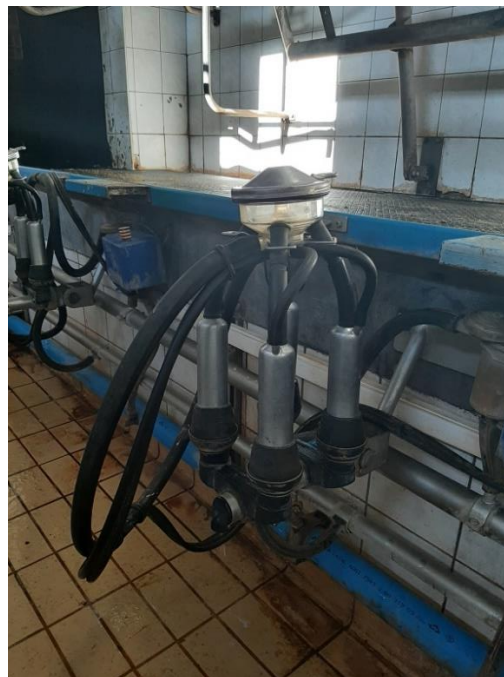
Slika 16. Muzna jedinica u položaju za pranje Izvor: Vlastita fotografija
