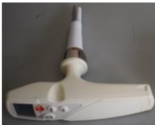
Slika 29. Digitalni pH metar (Testo 205, USA) Izvor: Skendrović Babojelić, 2021.
