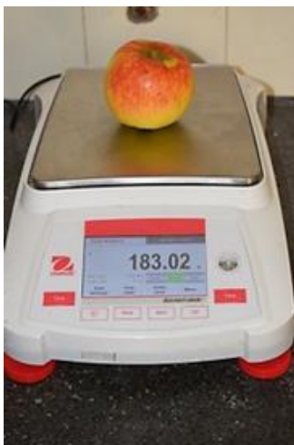
Slika 24. Digitalna laboratorijska vaga (OHAUS corporation, USA) Izvor: Skendrović Babojelić, 2021.
