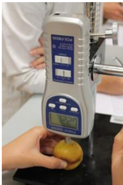
Slika 26. Digitalni stolni penetrometar (PCE-PT200, PCE Instruments, Southampton, UK) Izvor: Skendrović Babojelić, 2021.
