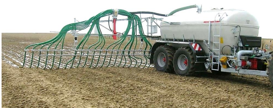
Slika 12. Primjena gnojovke izlivanjem po površini
