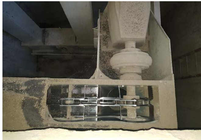
Slika 17. Transportna traka s lopaticama (tzv. elevator) (Fotografija: F. Rutić)
