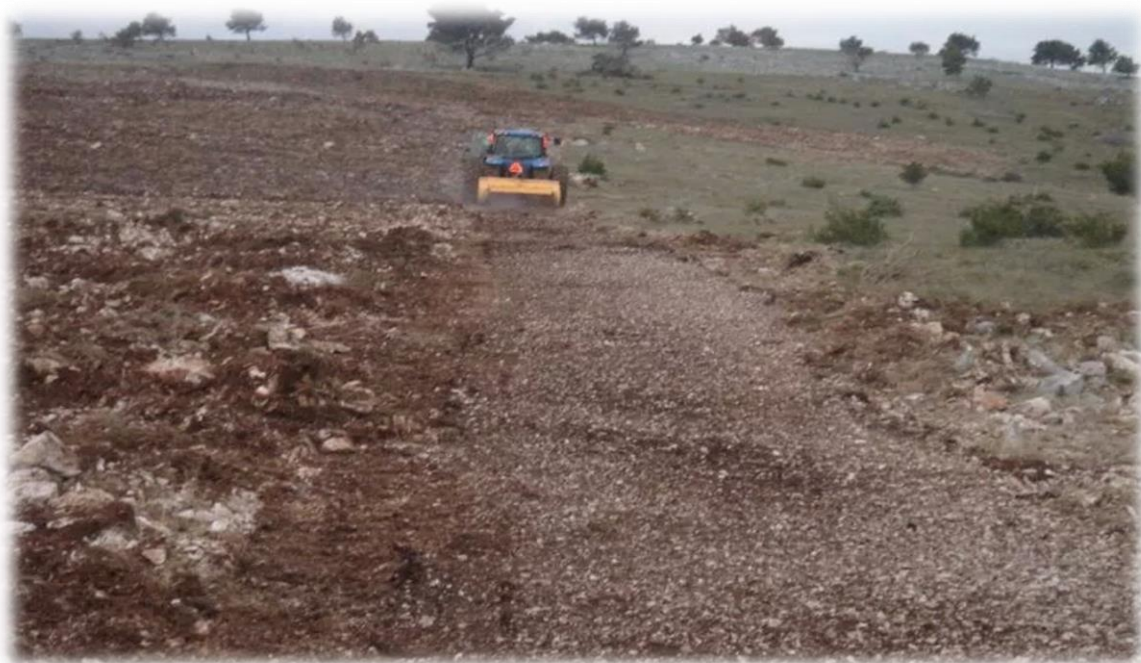
Slika 4: Prikaz rada uređaja za usitnjavanje kamena
