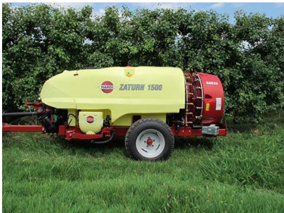
Slika 8. Vučeni atomizer - Hardi Zaturn u tvrtki Moslavina Energija d.o.o.
