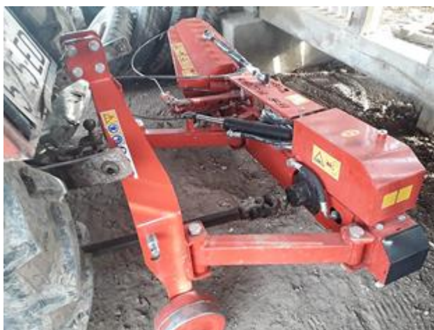
Slika 13. Voćarski kultivator s bočnim pomakom
