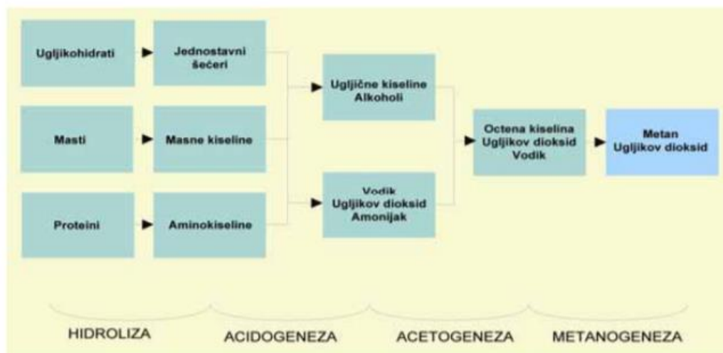
Slika 5. Glavne faze u procesu nastanka bioplina
