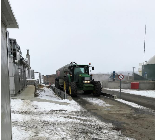
Slika 18. Ulazak traktora i cisterne na mosnu vagu
