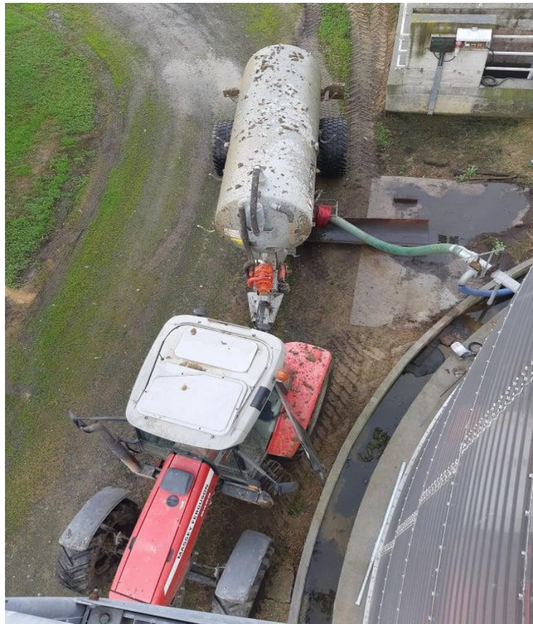
Slika 20. Princip punjenja slobodnim padom na OPG-u „Đuranec“ (Izvor: Vlastita fotografija)
