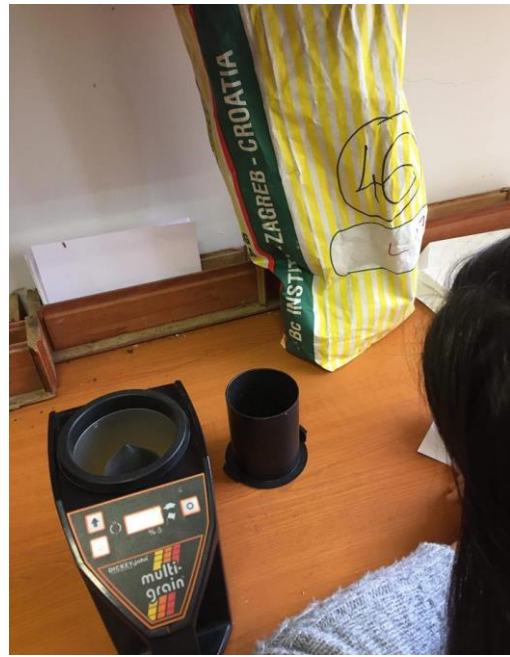
Slika 15. Mjerenje vlage zrna
