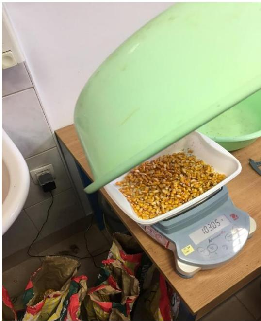
Slika 14. Mjerenje mase zrna s klipa
