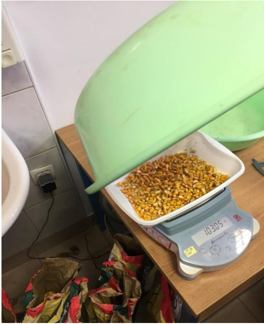
Slika 14. Mjerenje mase zrna s klipa
