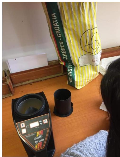
Slika 15. Mjerenje vlage zrna
