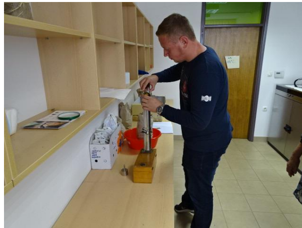
Slika 14. Određivanje hektolitarske mase
