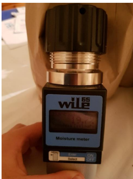
Slika 12. Aparat za mjerenje vlage Wile 65
