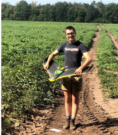
Slika 16. Uporaba bespilotne letjelice za snimanje vegetacijskih indexa (Izvor: Van den Borne)
