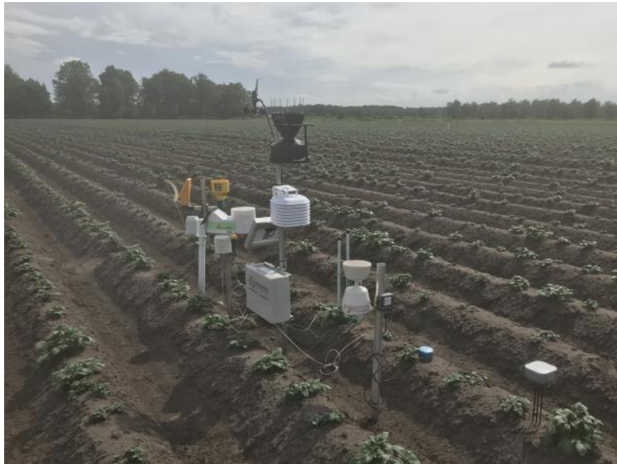
Slika 7. Mobilna stanica za vremensku prognozu (Izvor: Van den Borne)
