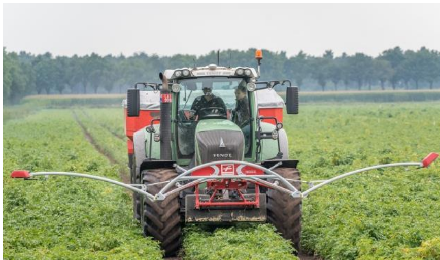
Slika 11. Varijabilna primjena mineralnih gnojiva uz pomoć N-senzora ( Izvor: Van den Borne )
