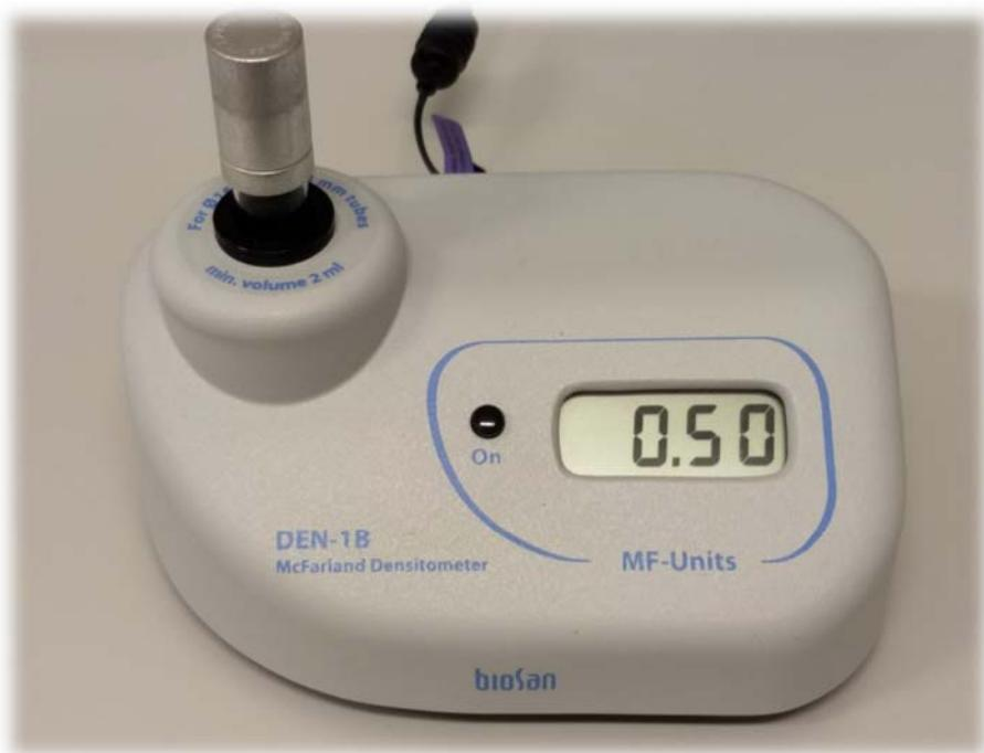
Slika 1. Denzitometar – uređaj za mjerjenje optičke gustoće suspenzije prema McFarlardu
