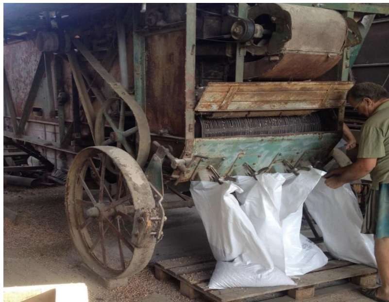
Slika 6. Prikaz dorade sjemena vršalicom MAF mađarske proizvodnje
