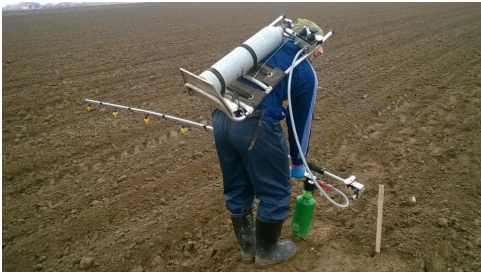
Slika 9: Upotreba ratarske prskalice namijenjene provođenju poljskih pokusa (snimio: F. Mesić)
