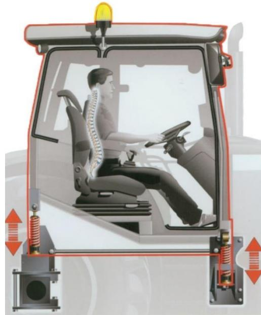
Slika 3. Shematski prikaz amortizacije kabine traktora
