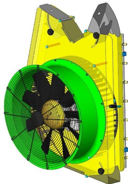
Slika 6. Shematski prikaz zaštitne mreže na ventilatoru
