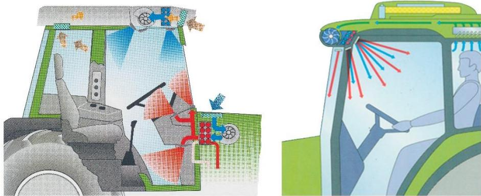
Slika 14. Traktorske kabine s filterom za pročišćavanje zraka
