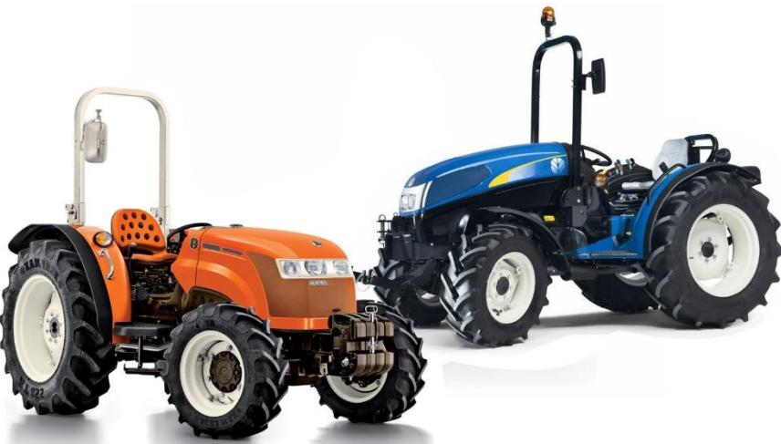
Slika 2. Prikaz traktora sa zaštitnim okvirom
