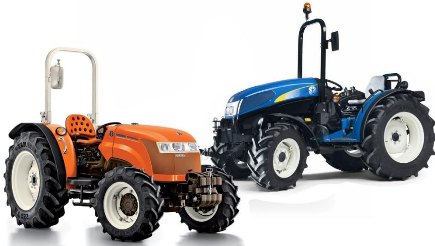
Slika 2. Prikaz traktora sa zaštitnim okvirom
