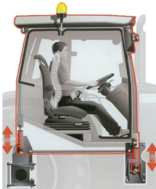
Slika 3. Shematski prikaz amortizacije kabine traktora
