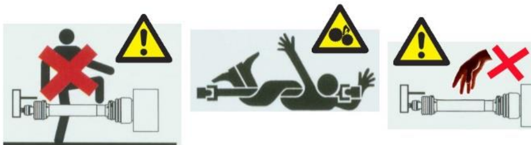
Slika 5. Primjeri označavanja za siguran rad s kardanskim vratilom
