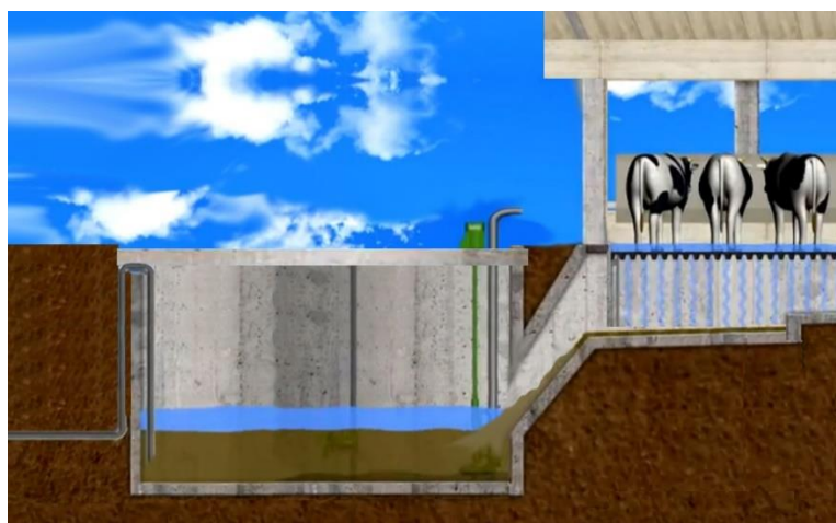
Slika 3. Shematski prikaz podzemnog spremnika za gnojovku
