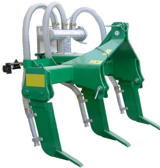
Slika 10. Prikaz uređaja za ulaganje gnojovke u tlo
