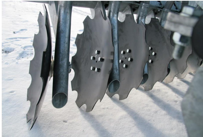
Slika 33. Prikaz diskosnog ulagača gnojovke
