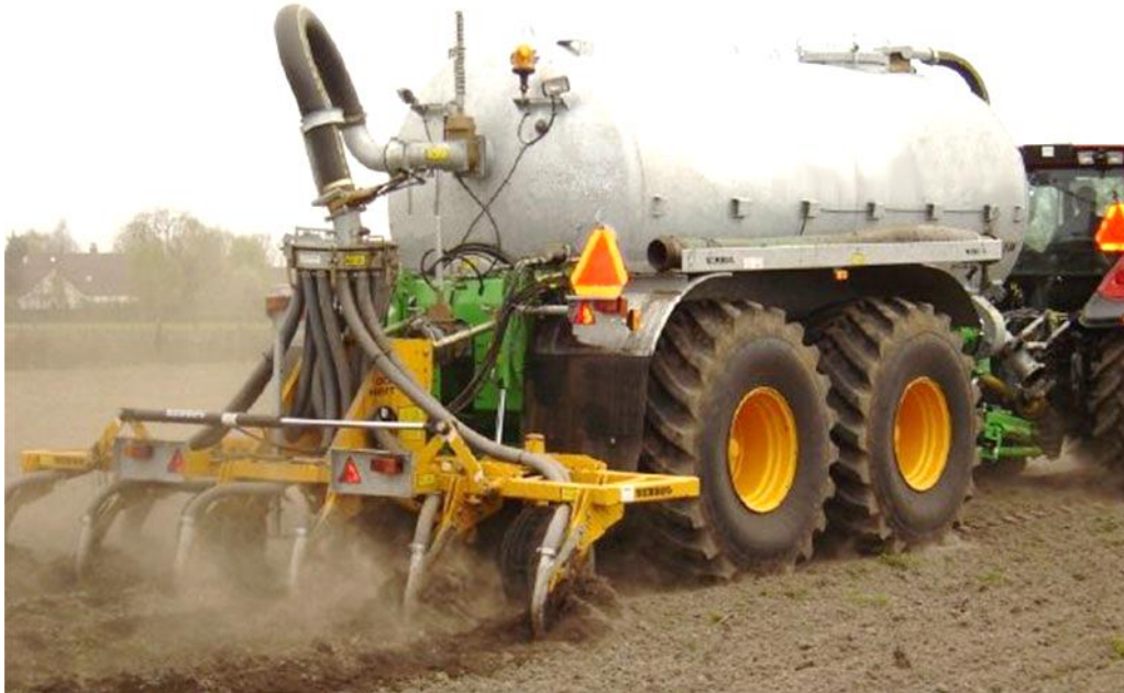
Slika 27. Prikaz uređaja za unošenje gnojovke u tlo u radu
