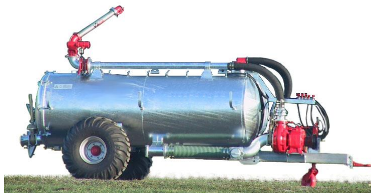
Slika 22. Prikaz sklopa za usmjeravanje mlaza (tyfon)
