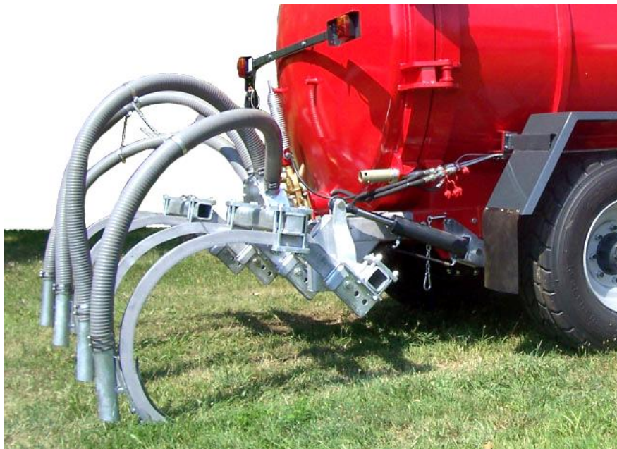
Slika 31. Prikaz raoniočnog ulagača gnojovke
