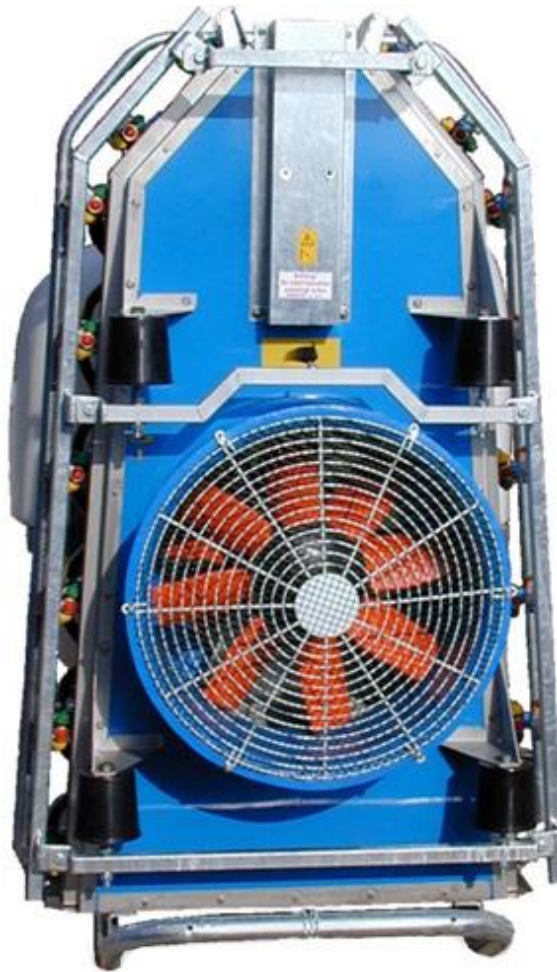
Slika 10: Ventilatori i visoki usmjerivač zraka
