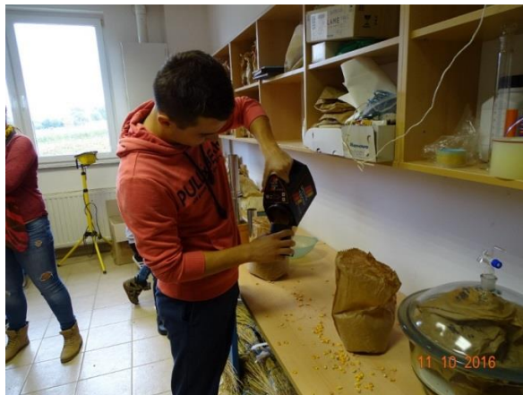
Slika 13. Mjerenje vlage aparatom Dickey John
