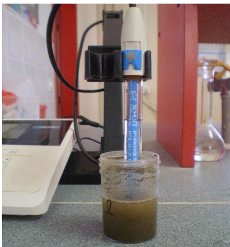
Slika 8. Određivanje kemijske reakcije tla pH metrom Izvor: Ana Kovač
