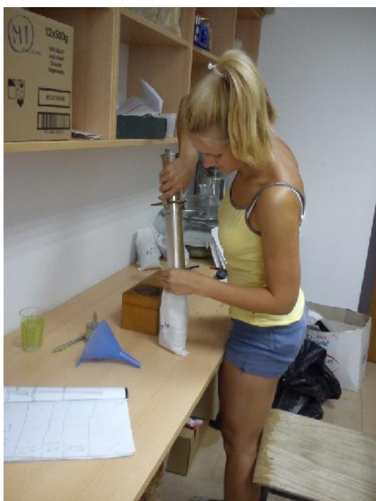
Slika 5 i 6. Određivanje hektolitarske mase
