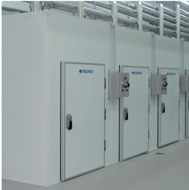
Slika 10. Komorna sušara za tjesteninu model EAC 180 – E C - elektro zagrijavanje
