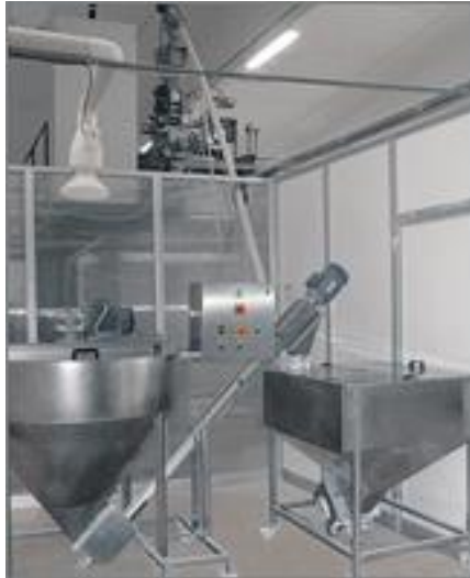
Slika 2. Automatski spiralni dozator-elevator ALC 450 za brašno / krupicu
