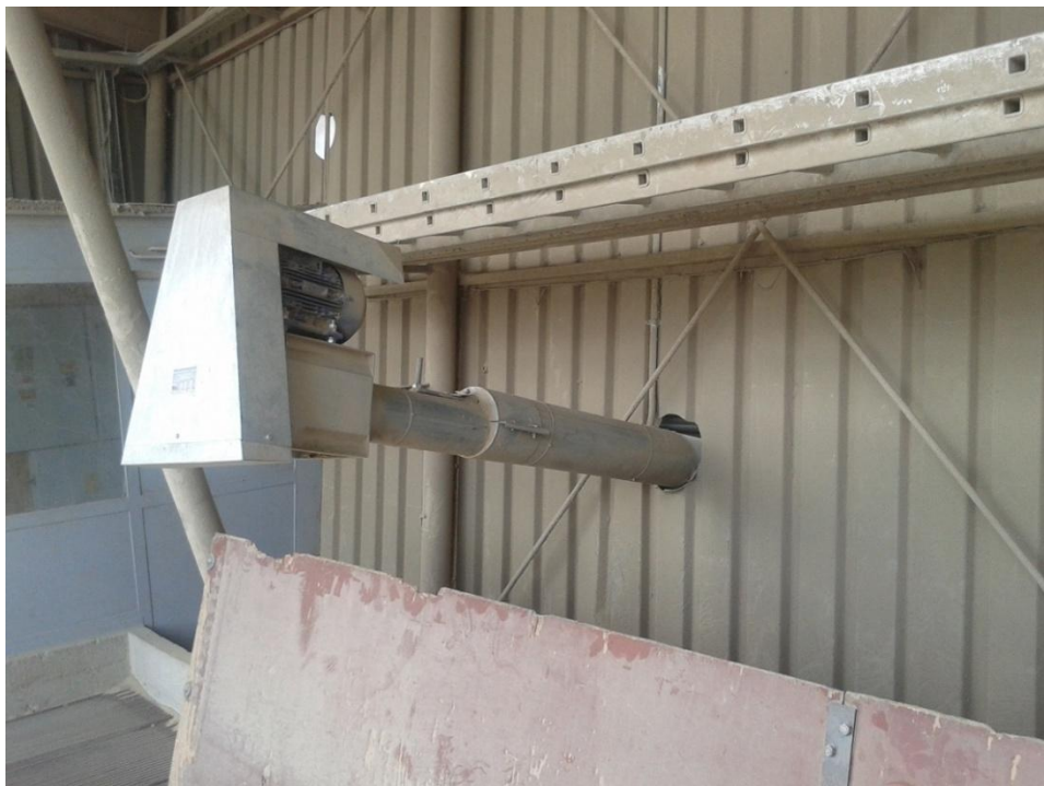
Slika 15. Pozicija 9 - izuzimanje merkantilne pšenice iz silosa 250 t Izvor: vlastita fotografija (16. srpanj 2014.)
