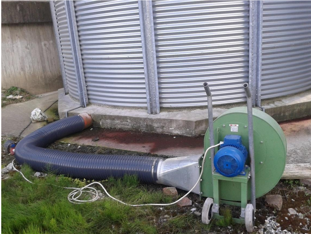
Slika 12. Pozicija 7 - aktivna ventilacija običnim zrakom
