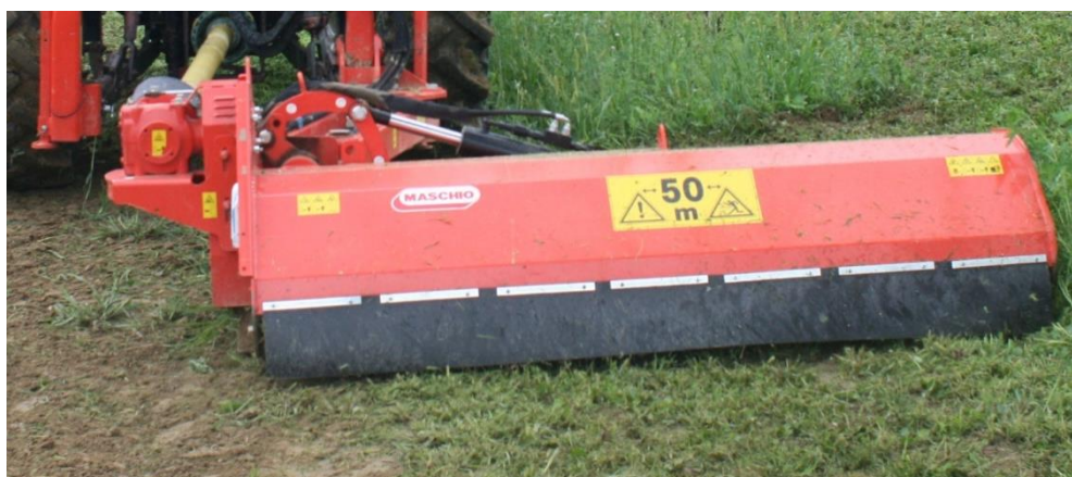
Slika 23. Prikaz označavanja sigurne udaljenosti M100 Izvor: M. Šešelj
