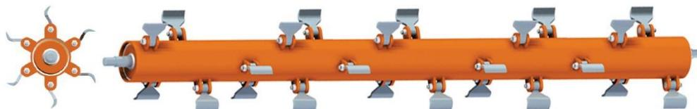
Slika 18. Shematski prikaz radne osovine uređaja za usitnjavanje
