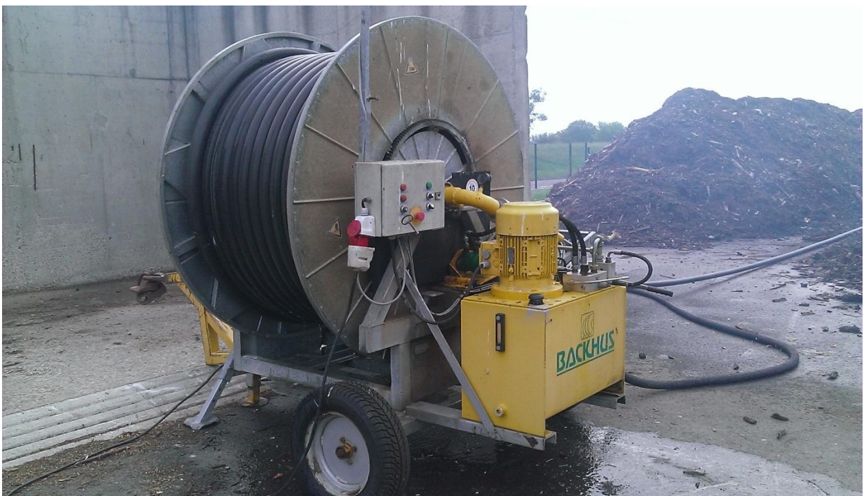
Slika 12. Sustav za ovlaživanje kompostne hrpe
