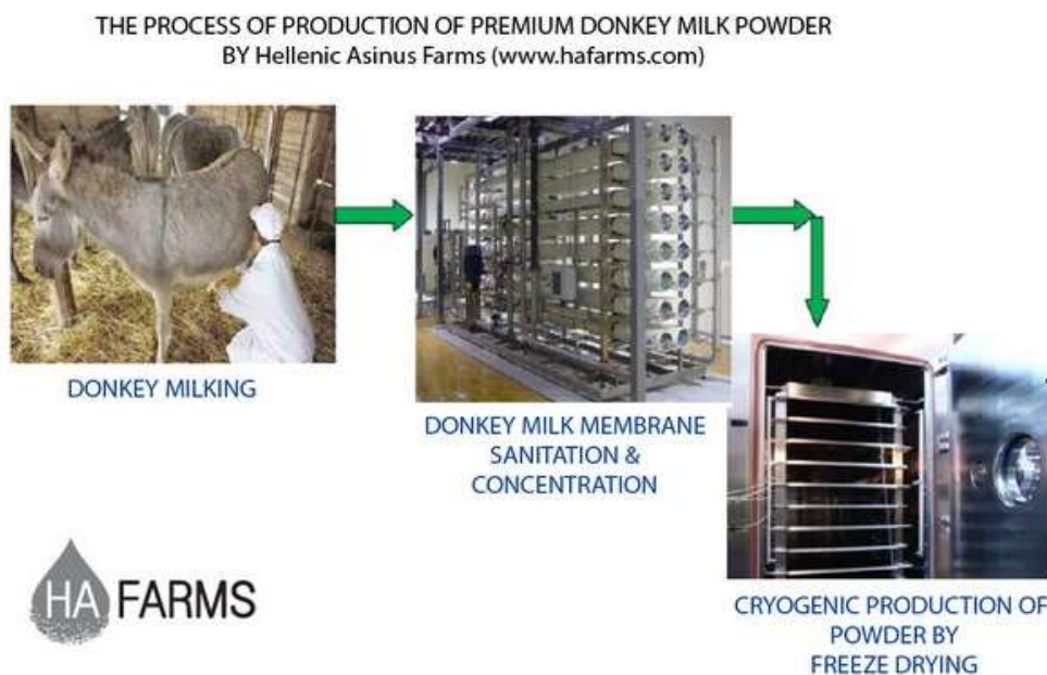
Slika 4.6. Proces proizvodnje premium magarećeg mlijeka u prahu
