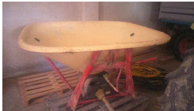
Slika 3. Rasipač mineralnoga gnojiva, Vicon 400 kg
