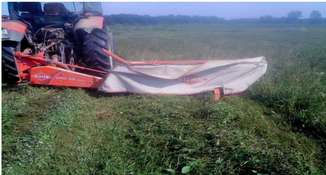
Slika 17. Kosilica s diskovima marke KUHN u radu
