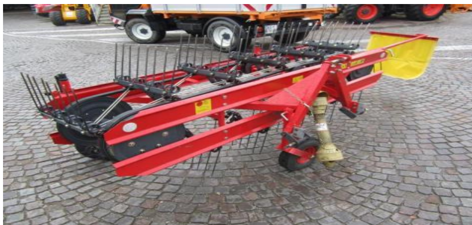
Slika 7. Okretač i sakupljač s beskonačnim remenom
