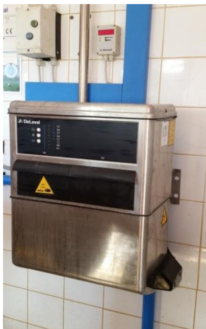
Slika 9. Aparat za pranje muznih jedinica
