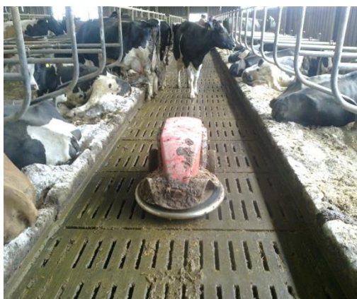
Slika 13. Robot za čišćenje rešetkastog poda marke „Lely“
