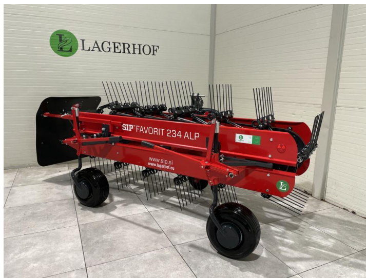
Slika 10. Grablje sa beskrajnom trakom s elastičnim zupcima (SIP).
