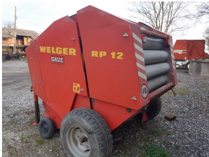
Slika 16. Preša za valjčaste bale s tlačnom komorom stalnog oblika (Welger).
