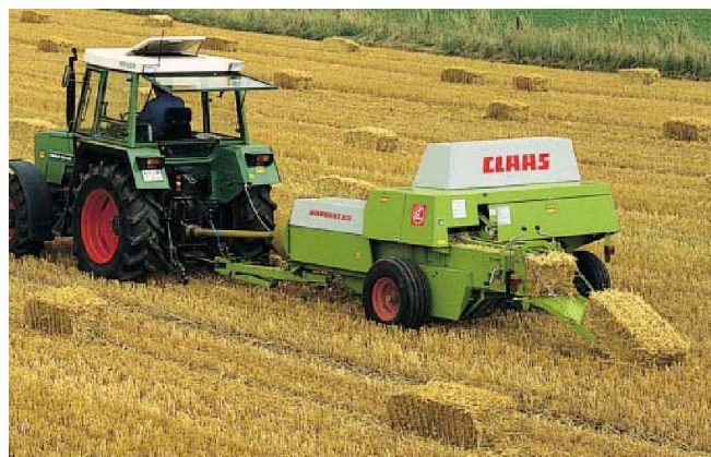
Slika 12. Preša za male četvrtaste bale (Claas).
