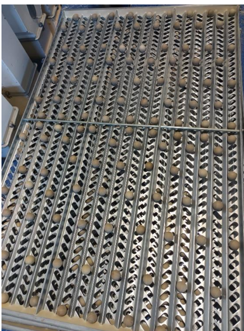
Slika 14. Gumene kuglice na rešetkama
