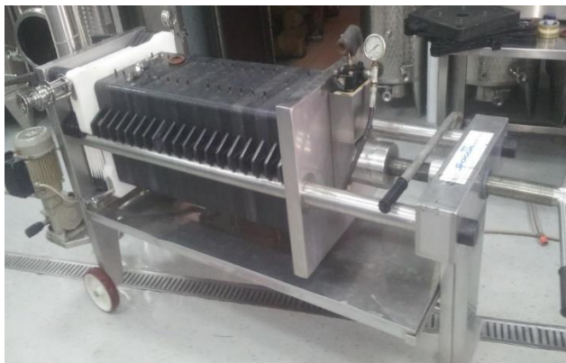
Slika 22. Pločasti filter Sfoggiatech Plus 40 Izvor: snimio T.Furjan
