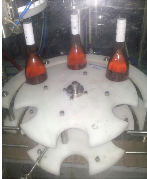
Slika 24. Zvijezda za prihvat boca u čepilicu Izvor: snimio T.Furjan
