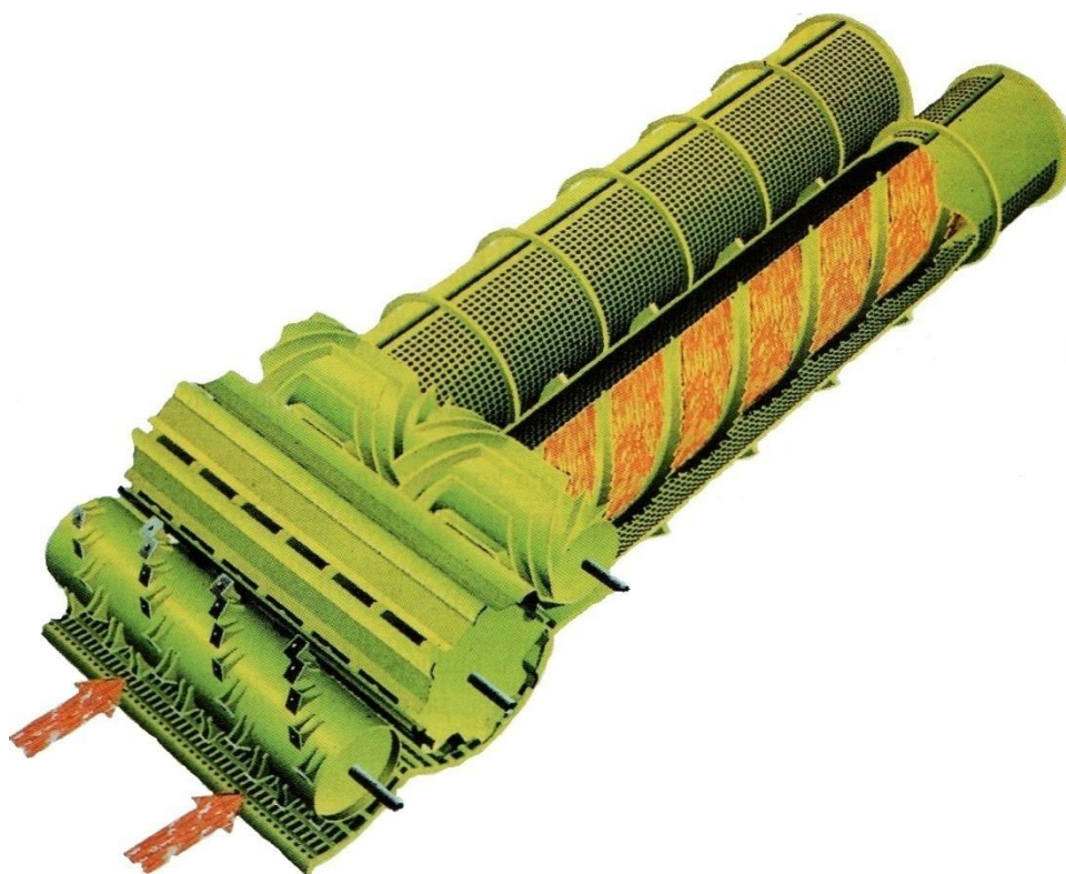
Slika 12. Kombinirani tangencijalni i aksijalni sustav vršidbe kod kombajna Claas Dominator
