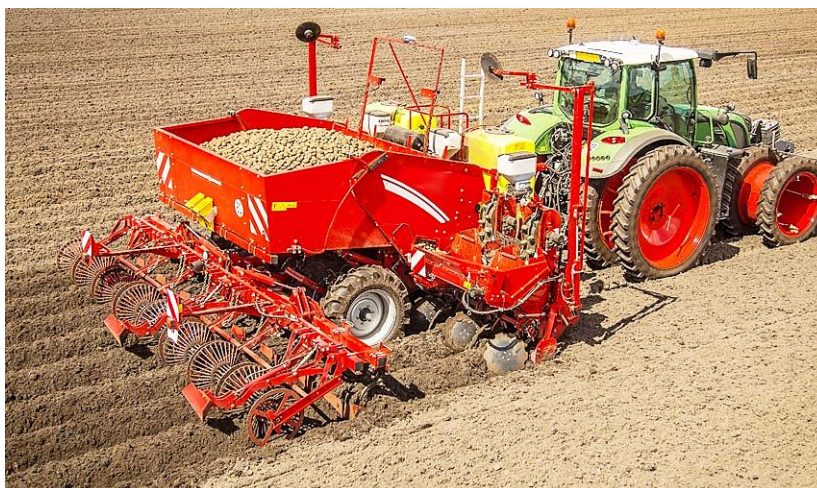
Slika 8. Automatska 8-redna sadilica za krumpir u radu
