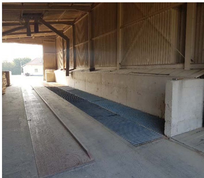
Slika 13. Usipni koš s nagibnom rampom za istovar
