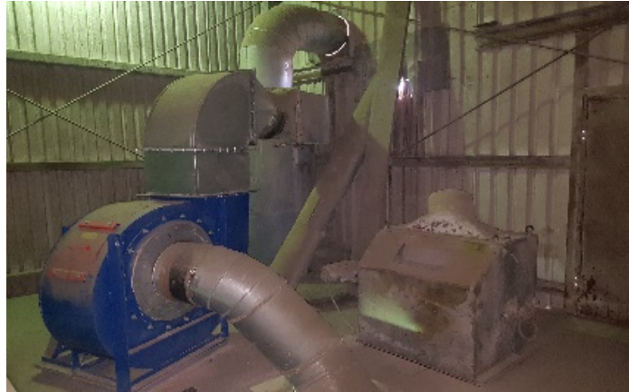
Slika 16. Ventilator koji stvara vjetar za propuhivanje zrnate mase (Fotografija: F. Rutić)
