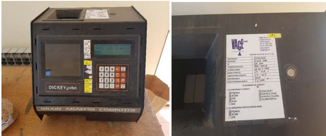
Slika 9 i 10. Uređaj Dickey John GAC 2100 i njegove specifikacije
