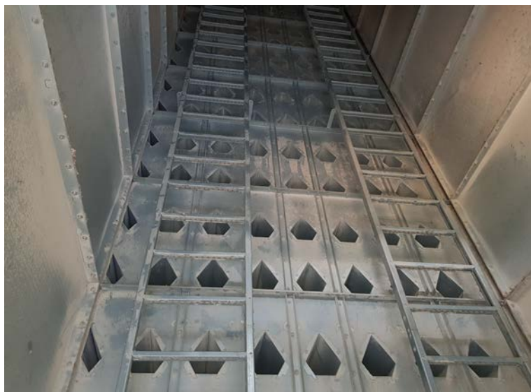
Slika 19. Prikazuje unutrašnjost sušare gdje s vide konusni žljebovi kroz koje prolazi zrnata masa, te se upuhuje vrući zrak. Žljebovi služe tome kako bi masa što sporije prolazila i da je dodirna površina veća, na taj način se zrnje puno brže suši.
