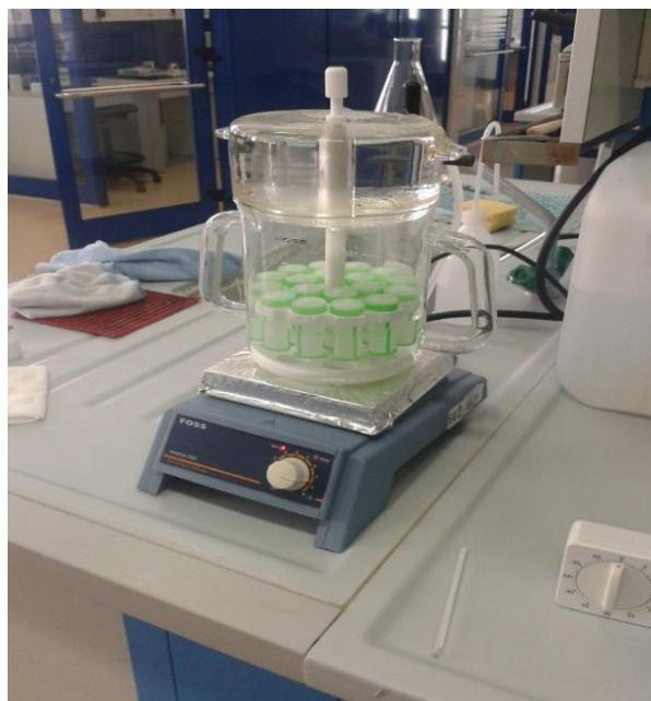
Slika 14. Analizator Fibercap za određivanje sirovih vlakana
