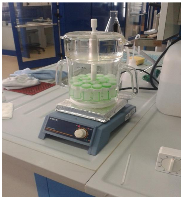
Slika 14. Analizator Fibercap za određivanje sirovih vlakana
