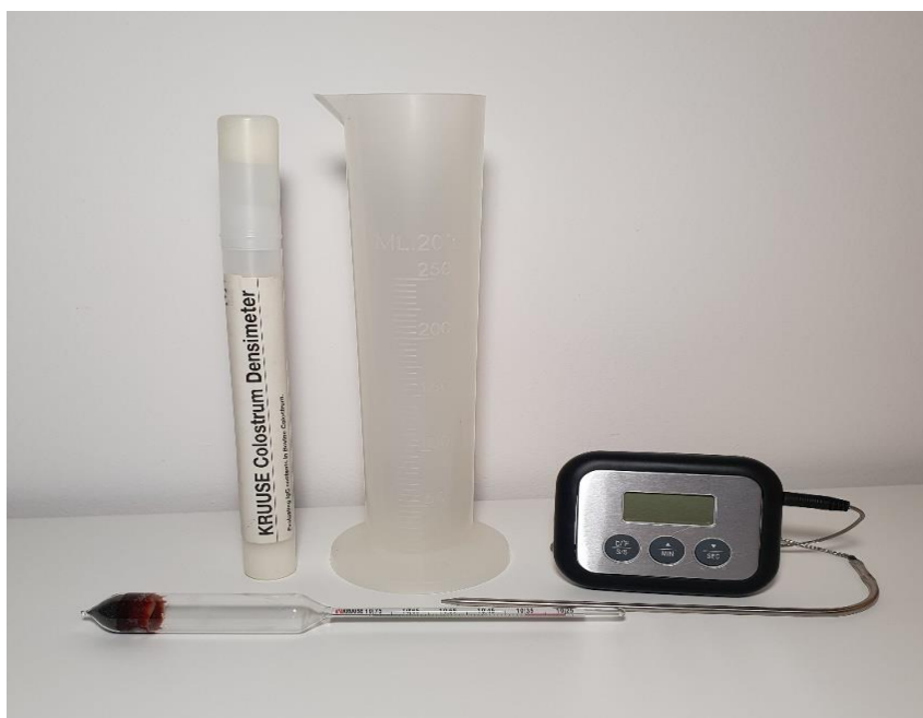
Slika 2. Pribor za mjerenje koncentracije imunoglobulina u kolostrumu
