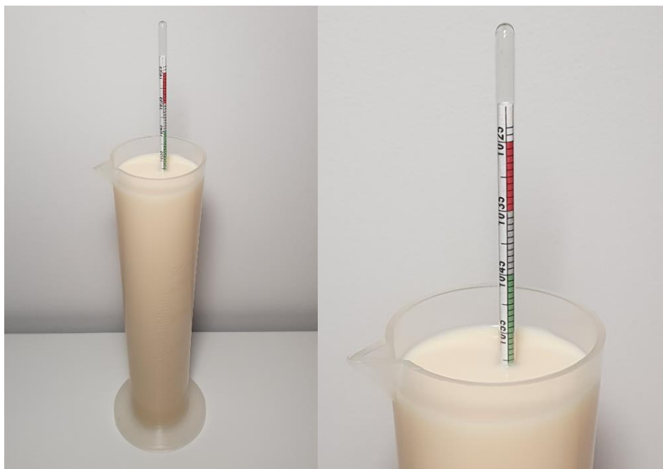
Slika 4. Prikaz mjerenja koncentracije imunoglobulina u kolostrumu
