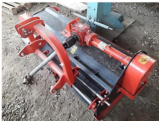
Slika 14. Malčer Serija A155 s mehaničkim bočnim pomakom Izvor: privatna arhiva
